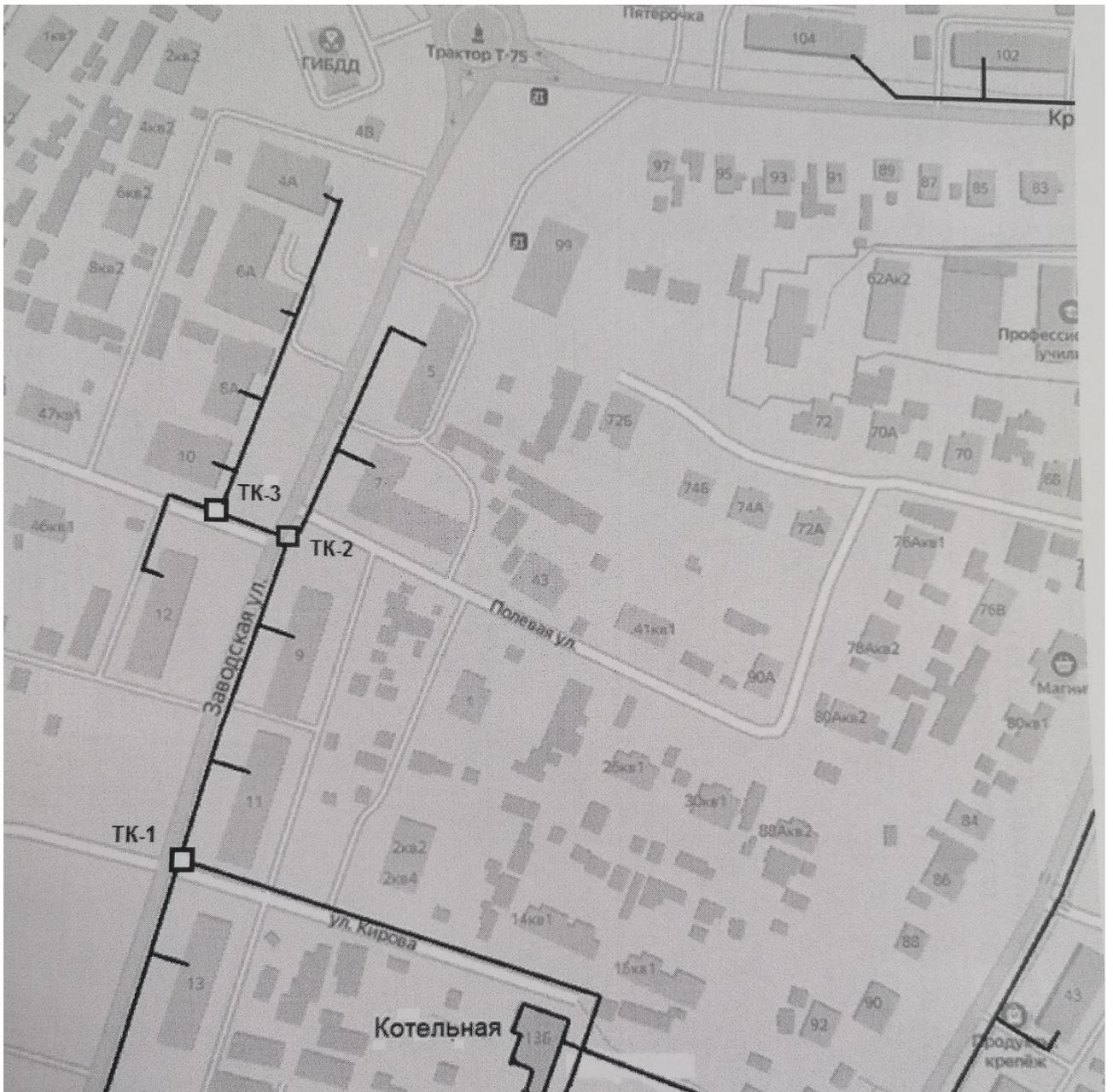
Рис. № 6 – Схема тепловой сети на участке от квартальной котельной до ул. Заводской
