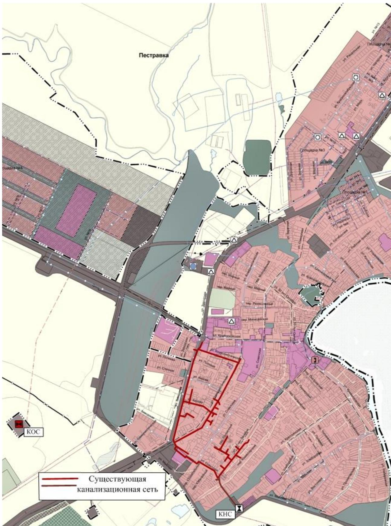
Рис. № 12 - Схема существующей системы централизованного водоотведения на территории села Пестравка
